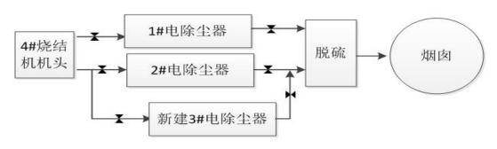
图 2-2 烧结机头除尘器工艺流程图
